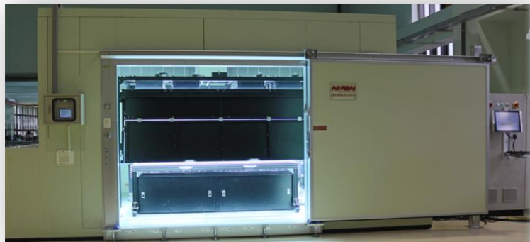
组件加速老化实验台
