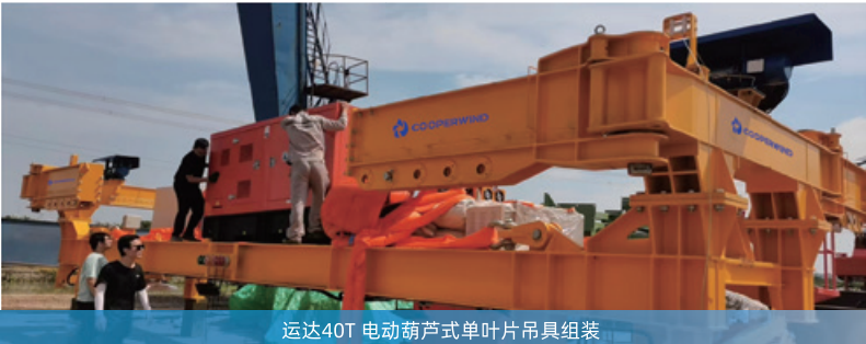
运达40T 电动葫芦式单叶片吊具组装
