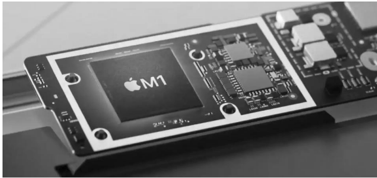
图 2-6 M1 是第一款使用尖端 5 纳米工艺技术制造的 PC 芯片，其中包含惊人的 160 亿个晶体管
