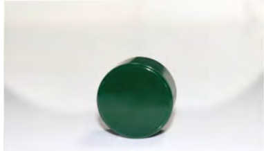
磨具倒角设计,样品自带倒角, 方面后续研磨抛光
